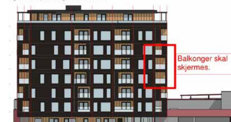
Figur 6 Tiltak på balkonger, fasade sørøst:
